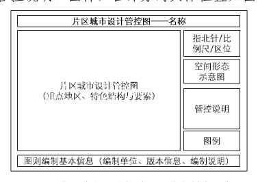
图 3-1: 片区城市设计导引图的基本版式示意
